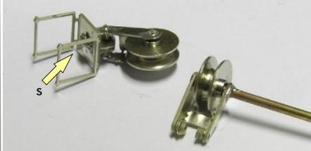
Die Haltenase am Abfanggelenk wird nun in die Öffnung des Masthalters geschoben und um 90° gedreht (s). Je nach gewünschter Abfangrichtung kann das Gelenk noch bewegt werden, bevor es endgültig festgelötet wird.
