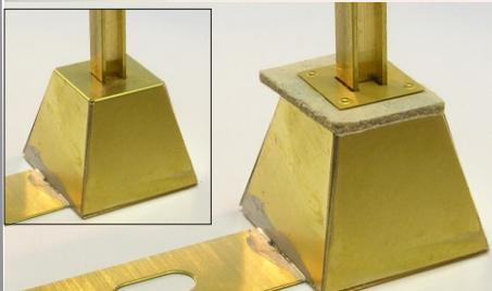
Für den nächsten Baufortschritt wird der gewünschte Mast in den Sockel gesteckt. Die Kartondistanzplatte wird an der gekennzeichneten Stelle ausgeschnitten und auf dem Sockel aufliegend an den Masten geschoben. Von oben kann nun die Mutterplatte über den Mast gestülpt werden. Die Mutterplatte kann an dieser Stelle fixiert werden.
