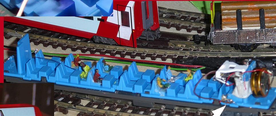
Stromanschlüsse bis hierher zwischen Innenraum und Wagenboden führen. Dabei zur Verminderung des Widerstands (Drähte können heiß werden!) etwas stärkere Drähte verwenden.
