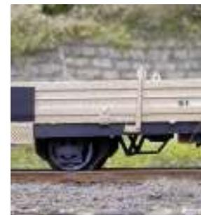
Bremsanlage und Rungendetails
