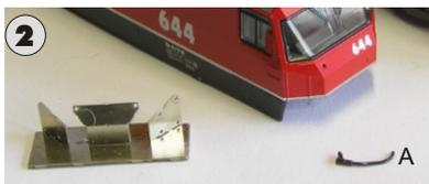
2. Ziehen Sie das Lokgehäuse vom Fahrwerk nach oben ab und entnehmen Sie auch die Heizleitung (A), damit Sie eine möglichst glatte Anlagefläche für die Bohrschablone haben.
