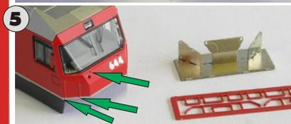
5. Bohren Sie beide Gehäusefronten, jeweils 10 Löcher (siehe u.a. die grünen Pfeile), und säubern Sie anschließend die Front und die Innenseite von Plastikspänen.
