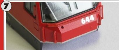
7. Die eingesteckten Handläufe werden von innen (!) mit wenig Sekundenkleber fixiert. Lassen Sie unbedingt den Klebstoff gut ablüften, bevor Sie das Gehäuse wieder aufsetzen, denn die Klebstoffdämpfe könnten sich auf den Glasscheiben der Front als weißer Schleier niederschlagen.
