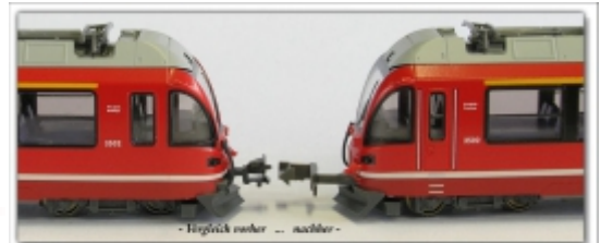
KT-101.5: Umbau Allegra von Kato-Kurz- oder Modellkupplung in Arnold-Rapido-Kupplung, inkl. Material, o. Fahrzeuge
