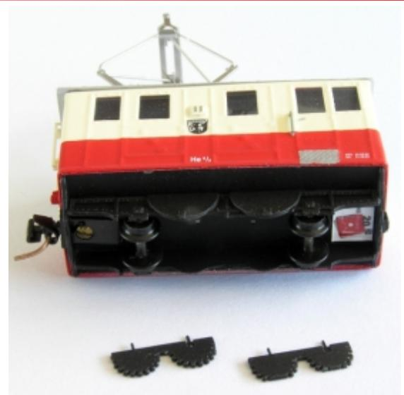
Dem Rollmodell liegen zwei „Antriebs“-Zahnradnachbildungen bei. Links mit vollem Zahnkranz, zum Einhängen in unser Zahnstangengleis und Präsentation auf einem Diorama, rechts mit abgeschnittenen Zähnen als Schiebemodell. Die gewünschte Ausführung kleben Sie wahlweise unter Ihre Lok.
