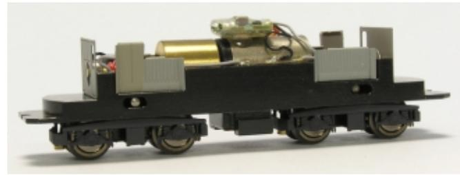
Fahrwerk mit aufgeklebtem Zimo MX616-Decoder. Bei aufgesetztem Gehäuse findet der Decoder unter der Abdeckhaube Platz und ist praktisch unsichtbar.
