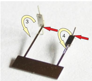
Nun drehen Sie das Bauteil um. Die Platte mit den Schraubenimitationen wird nun auf den langen Steg geklappt, der die Tafel hält. Die Biegelinie wird durch die roten Pfeile verdeutlicht. In Schritt 3 wurde erstmal nur um 90° die Platte umgebogen, in Schritt 4 bereits um 180°. Am Schluss müssen beide Platten um 180° glatt auf den langen Stegen aufliegen.
