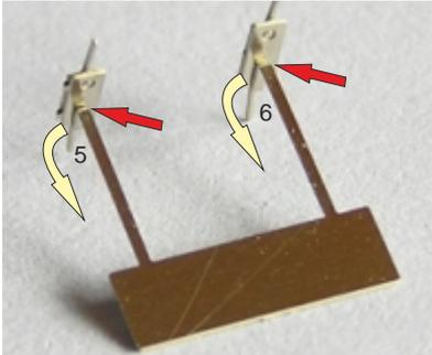
In Schritt 5 und 6 biegen Sie nun die Platte wieder um 90° zurück, so dass die Stege senkrecht auf der Platte mit den Schraubenimitationen aufsteht. Die Biegelinie wurde erneut mit einem roten Pfeil gekennzeichnet. Sichern Sie diesen Bauschritt nun mit Klebstoff an den Verbindungsstellen der einzelnen übereinander liegenden Platten. Nicht die langen Halterungen festkleben!
