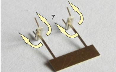
Die so vorbereitete Tragwerktafel wird nun unter das Quertragwerk montiert. Dazu werden die langen Haltestege von außen um das Tragwerk gelegt und dort nach dem Ausrichten festgeklebt.
