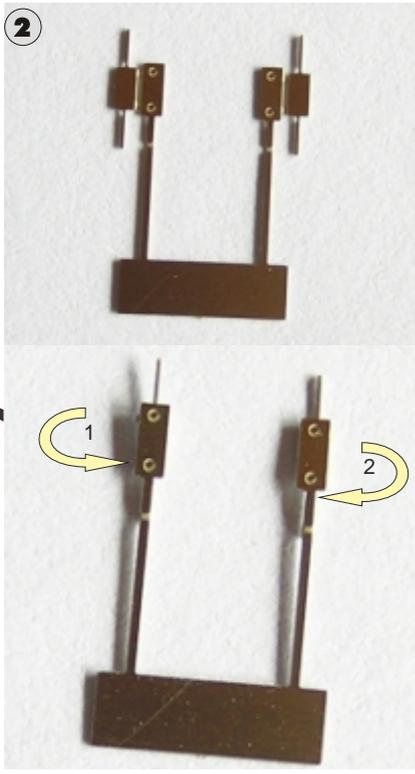
2. Entnehmen Sie das Bauteil A aus dem Ätzrahmen. Es ist vier Mal im Bausatz enthalten. Alle Tragwerkstafeln werden nach dem gleichen Muster zusammengesetzt.
