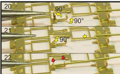
20. Am Fahrleitungshalter F wird die vordere Öse um 90° nach oben gebogen. Auch der Anschlag wird im ersten Schritt um 90° nach oben gebogen (Ätzlinie liegt außen).
