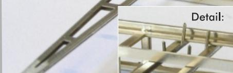
Die Stütze wurde nun verlötet (Bild f) und hält sicher im Tragwerk. Schneiden Sie die überstehenden Hilfsstege mit einem Seitenschneider ab.
