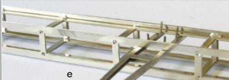
Klemmen Sie das Bauteil nun in das vorbereitete Quertragwerk (Art.-Nr. 0m-855.x) und biegen die Hilfsstege noch etwas weiter auseinander, damit es sicher hält. Bevor die Teile miteinander verlötet werden, richtet man sie noch gerade aus.
