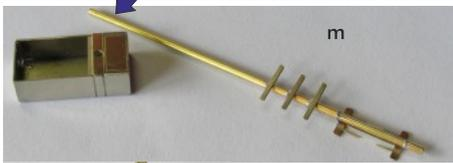
Die vorbereiteten Bauteile, Leuchtgehäuse und Montagerohr liegen für den Zusammenbau bereit. **WICHTIG:** wenn Sie die Gleisfeldleuchte mit einem Leuchtmittel ausstatten wollen, so müssen Sie jetzt in den Teil des Röhrchens, der im Gehäuse verschwindet, seitlich ein Loch feilen (blauer Pfeil), durch welches Sie die Kabel für die Beleuchtung ziehen können.
