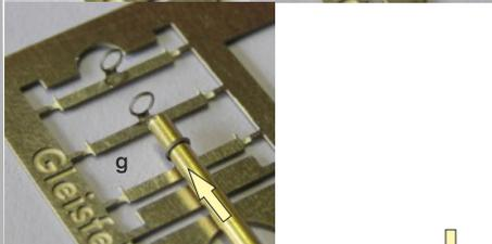
Durch die Ösenreihe schieben Sie nun das Röhrchen (Teil 5) in Pfeilrichtung (Abb. g). Sollte ein Grat vom Kürzen des Röhrchen stören, so schleifen Sie das Ende des Messingrohrs leicht mit feinem Schmirgelpapier an, damit das Durchschieben ohne Probleme gelingt. Bitte keine Gewalt anwenden, sonst verbiegen die filigranen Ösen.
