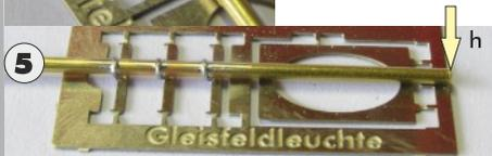
Schieben Sie das Röhrchen soweit durch die Ösen, bis ein Ende des Rohrs mit dem Ätzblech abschließt (siehe Pfeil in Abbildung h). Das Rohr und die Ösen können jetzt miteinander verlötet werden.
