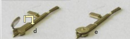
Zuerst klappt man den Deckel der Antriebswelle um 180° auf das Blech (Abbildung d und e).
