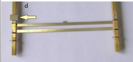
Die Warntafel (2) wird über eines der beiden Profile gesteckt (d). Die Tafel liegt oben.
