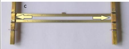
Der untere Quersteg für die Antriebe (Teil 1) wird über die Masten gesteckt (c). **Die Profile liegen unten!**
