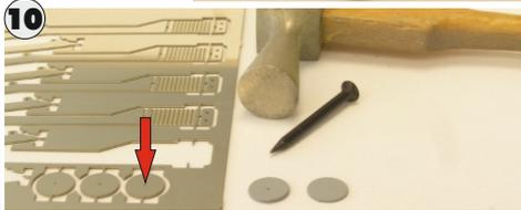
10. Die Deckel werden für die Rundmasten aus Holz benötigt. Mit einem Stahl Nagel und einem kleinen Hammer wird in das mittige Loch geschlagen. Als Unterlage empfehlen wir ein weiches Holzreststück, so dass sich der Deckel wölbt.
